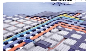
フリーアクセスフロアのイメージ (OAフロアと同意)
